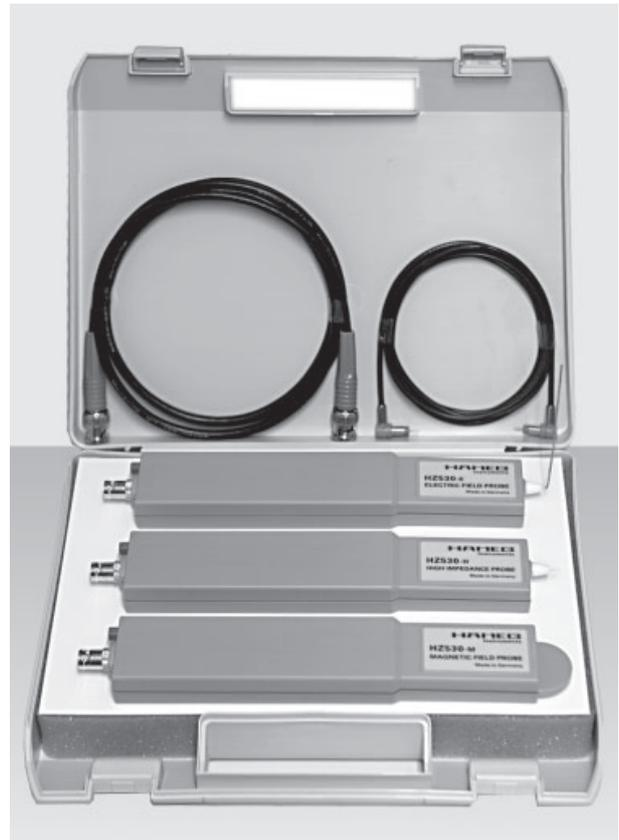
von ICs als Störer identifiziert und innerhalb von Leiterplatten können problematische Leiterbahnen ermittelt werden. Mit dieser Sonde kann man jeden einzelnen Punkt einer Schaltung direkt dem Spektrumanalysator zugänglich machen.
