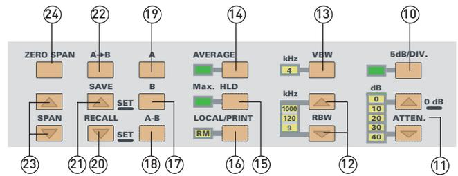
**Kurzer Tastendruck:** Mit einem kurzen Tastendruck lässt sich die Funktion aufrufen. Dann zeigt der Bildschirm rechts oben z.B. „RECALL9“ an. Solange RECALL... eingeblendet ist (ca. 2 Sekunden), können mit kurzem Betätigen der RECALL- bzw. der SAVE-Taste 21 Speicherplatzziffern zwischen 0 und 9 gewählt werden. Durch das Betätigen der SAVE- bzw. RECALL verlängert sich die Zeit der Platzzifferneinblendung.
