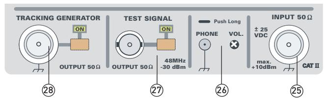
Der Außenanschluss der N-Buchse ist mit dem Chassis und damit galvanisch mit dem Netzschutzleiter verbunden.
