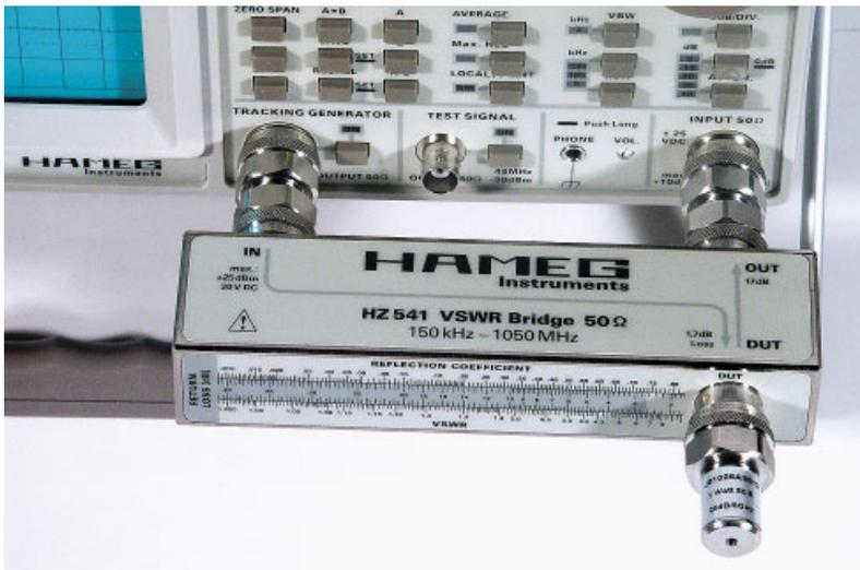
IN-Anschluss mit Tracking-Generator (HM 5014-2) verbunden (Signalquelle)
